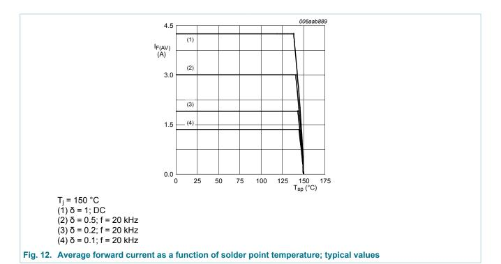
3 A low VF MEGA Schottky barrier rectifier
